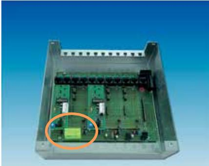
Para establecer la función Apertura de Emergencia global (apretando el pulsador Apertura de Emergencia en una puerta desbloquea todas las puertas de la instalación) debe reequipar el relé suplementario enchufable en la maniobra central RJ, Art. N° 710953. Se enchufe simplemente en el lugar previsto (ver abajo!).
