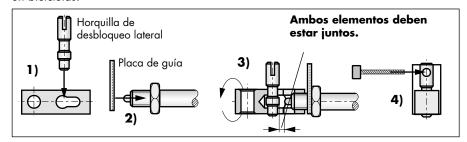
El dispositivo de desbloqueo para cable Bowden se atornilla en el vástago, roscado en su parte superior. El cable no forma parte de la entrega, por su longitud necesaria siempre diferente.
