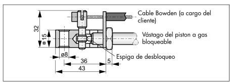
El dispositivo de desbloqueo para cable Bowden debería utilizarse si no es posible liberar el bloqueo directamente sobre el pistón. En los asientos de los aviones por ejemplo, el desbloqueo del respaldo se efectúa mediante un botón en el brazo del asiento.
