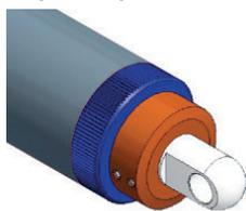
**Bloqueo de ajustes para DIREKT con agujeros:** El bloqueo de ajustes se introduce por el agujero y se asegura con dos tornillos sin cabeza. La presión sobre la rueda dentada impide que pueda girarse y que así puedan cambiarse los ajustes.
